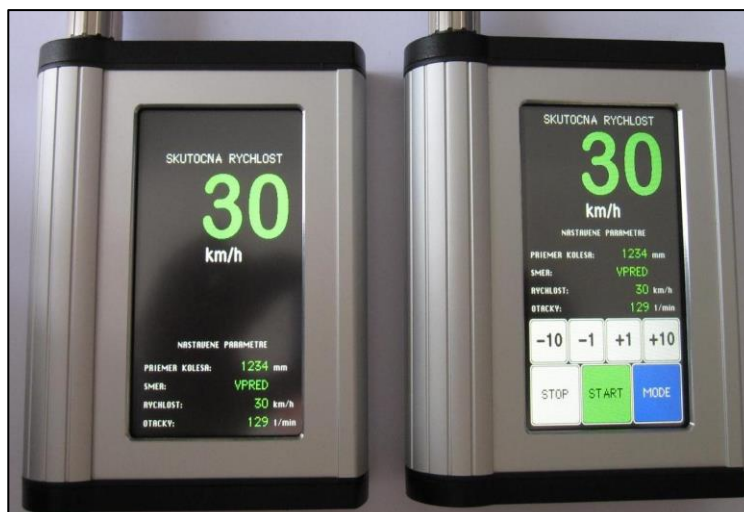
Obr.3: Ovládacie terminály HMIMM Pasívny (vľavo) a Aktívny (vpravo)
