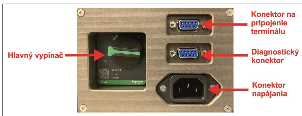
Obr.5b: Popis hlavného panela pohonnej jednotky IRCP.3.A
