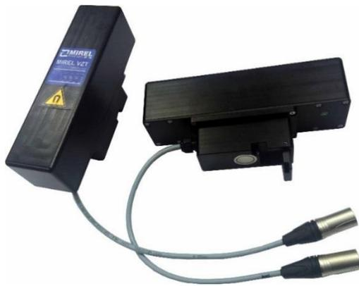
Das Zubehör, Sender des simulierten Code wird unter dem Codeabnehmer des Typs MIREL SN direkt am Gleis positioniert. Ein Kippanschlag an der Unterseite dient der richtigen Positionierung am Gleis. Die Position ist mit einem Permanentmagnet im KSV-Fuß fixiert. Die Platzierung erfolgt immer paarweise und unter dem Abnehmerpaar. Für ihren Anschluß an die Steuerungselektronik dient das PKSV-Zubehör. Standardmäßige Zusammenstellung beinhaltet zwei KSV-Sender.
