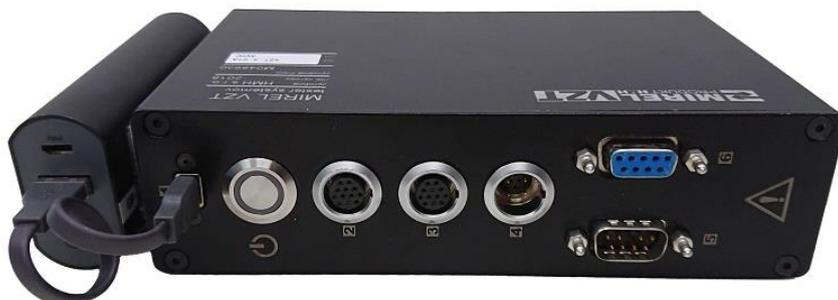
Die VZT.4-Steuerungselektronik kann man aus dem Koffer herausnehmen und separat verwenden. Zu diesem Zweck verfügt Seitenwand von Instrumentenbox über die Möglichkeit zum Anschluß des Zubehörs von tragbarer PBUSS-Versorgungsquelle, mit Hilfe von lösbarer Verbindung, damit diese zusammen eine separate Einheit bilden. Der Kasten der VZT.4-Steuerungselektronik ist auf einer Seite mit rutschsicheren Instrumentfüßen ausgestattet
