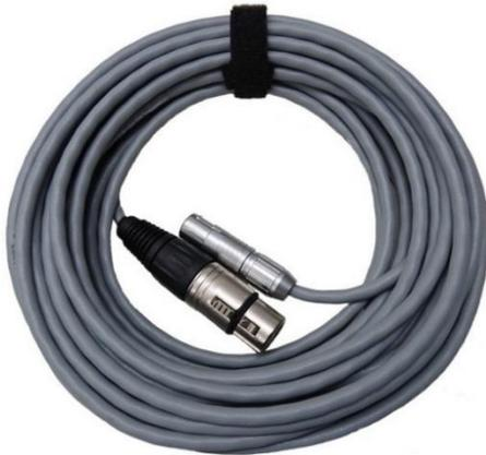
Das Verlängerungskabel der Code-Simulationsschleife dient zur Verlängerung der Leitung zum KS-Zubehör. Das Kabel hat eine Länge von 10 Meter, an einem Ende mit XLR-Verbindungsstück zum Anschluß des KS-Zubehörs beendet, an anderem Ende mit dem MiniCon MRM1-Konnektor beendet, zum Anschluß an das VZT.4-Gerät (Verbindungsstück Nr.3).
