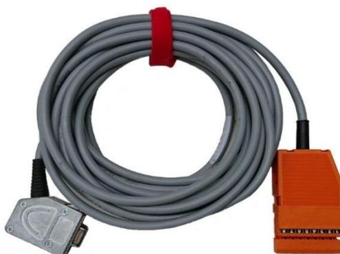
Das Zubehör, Anschlußkabel zur Simulation des Drehzahlgebers dient zum Anschluß der VZT.4-Steuerungselektronik an die Drehzahlgeberklemmleiste an der TFz-Achse. Seine Länge beträgt 8 Meter. Auf der Seite der VZT.4-Steuerungselektronik (Steckverbinder-Nr.5) wird mit einer D-sub Steckbuchse angeschlossen (im Bild links), auf der Seite der TFZ-Klemmleiste wird der Leiter mit einem WAGO – M - Steckverbinder angeschlossen (im Bild rechts) .
