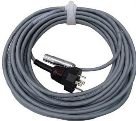
Verlängerungskabel-Zubehör für die Simulation von Druckgeber. Das Kabel ist 8 Meter lang, auf einer Seite mit einem MSCF-Steckverbinder des Typs MiniCon zum Anschluß an die VZT.4-Steuerungselektronik (Steckverbinder-Nr.4) beendet, auf dem anderen Ende mit einem Industrie-Rund-Steckverbinder, Typ A 3P-PE zum Anschluß an den Steckverbinder mit dem MIREL ST-Druckgeber beendet.
