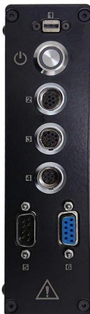
1. Industrie-Ausführung von Micro-USB-Steckverbindungsstück. Dient als Versorgungsverbindung für den Anschluß von PBUSS-Zubehör.
