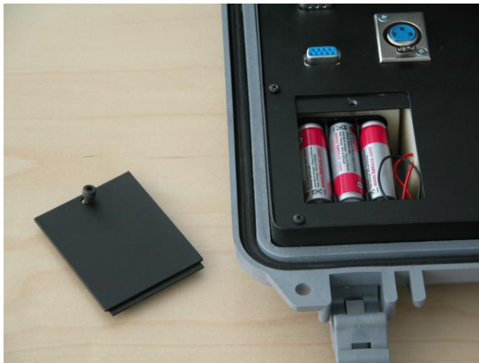
Öffnen des Gehäuseraums für die Batteriequelle PWR. Am Gehäuse ist die Sicherungsschraube sichtbar.
