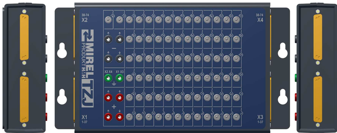
Obr. 1 TZJ.1.0 tester základnej jednotky – prepojovací box
